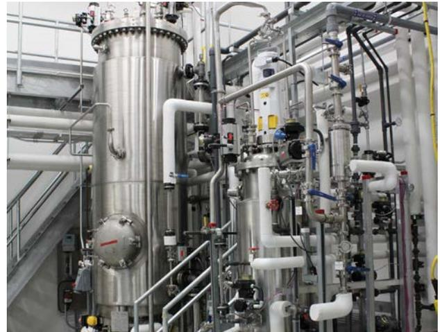
Hydrolyseurs de 150 et de 2000 litres
