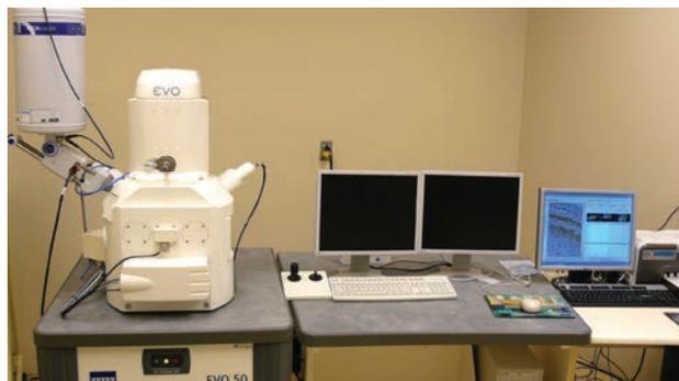
Microscope électronique à balayage (MEB)
