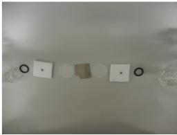
Figure 58 : Photographies montrant la cellule de perméation montée ainsi qu'une vue éclatée des différents éléments la constituant.
