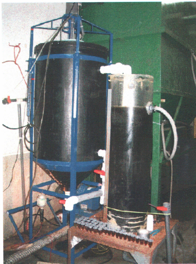
Figure 2.3 : Réacteur de 450 L avec colonne secondaire de décantation pour la précipitation de la struvite en continu
