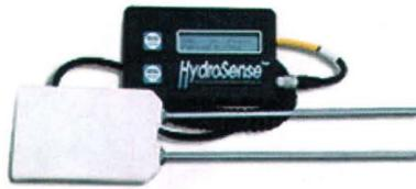
Figure 3 : Appareil HydroSense CS620 de Campbell Scientific.
