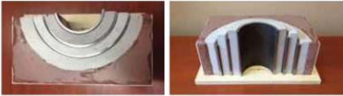
Figure 5 - Exemple de la structure du ciment à l'intérieur d'un puits (CSUR, Canadian Society for Unconventional Ressources).
