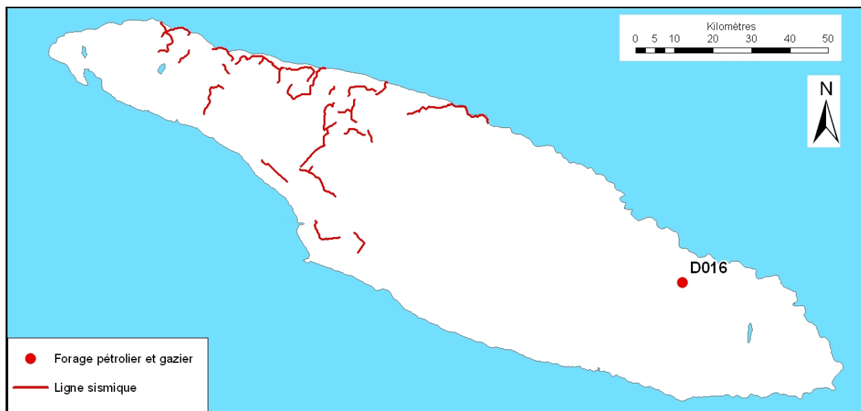
Figure 16 : Localisation du puits et du levé sismique pour lesquels des pertes de circulation de fluides de forage sont documentées à faible profondeur sur l'île d'Anticosti. Ces profondeurs sont de 0 à 2 m pour le puits D016 et de 3 à 12 m pour les trous destinés à recueillir les charges dans le cas du levé sismique.
