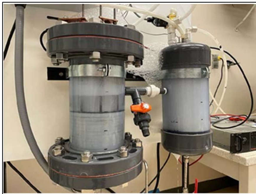
Figure 21 Photographie du réacteur ECA et du réservoir du Skid 2 au début de l'injection d'O 2 dans la boucle de recirculation; Présence apparente de mousse, le réservoir de mélange étant complètement rempli de mousse. Une certaine quantité de mousse s'est retrouvée à l'extérieur du système (en passant par le système d'évent)
