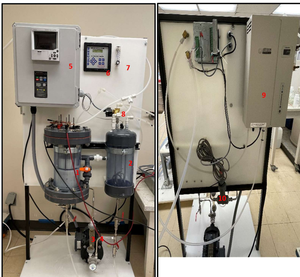
Figure 6 E-Peroxone; face devant (a), et face arrière (b). Différentes parties du réacteur incluant: réacteur AEO (1), réservoir (2), pompe (3), débitmètre (4), contrôleur et acquisition de données (5), panneau de contrôle (6), Régulateur de débit de gaz auxiliaire (7), contrôleur de température et bobine (8), générateur d'ozone (9), sonde pH (10).
