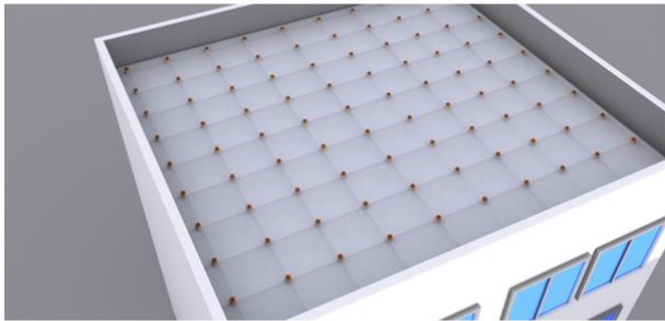
3. Une couche de 1 cm de mousse de polystyrène utilisée pour créer une surface lisse pour les couches supérieures.
