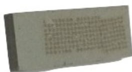
Figure 3-3 Exemples de matériaux de référence sous la forme de pastilles comprimées
