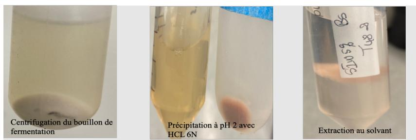
Figure 4.4 Étapes d'extraction des composés du bouillon de fermentation
