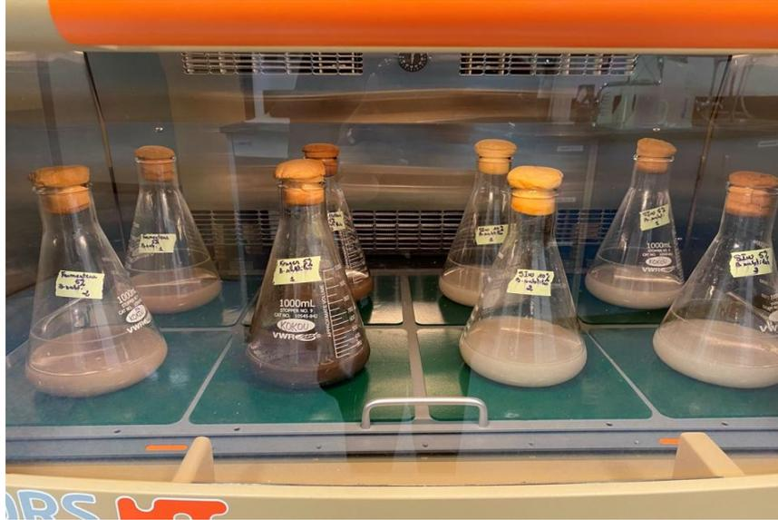
Figure 4.5 Exemple de fermentation en erlenmeyers avec *Bacillus subtilis*
