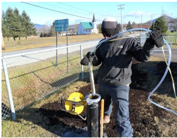
Figure 12 : Pompes utilisées pour la purge et l'échantillonnage des puits d'observation
