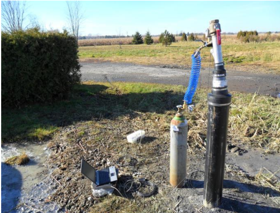
Figure 11 : Instrumentation pour l'essai de perméabilité pneumatique sur un puits
