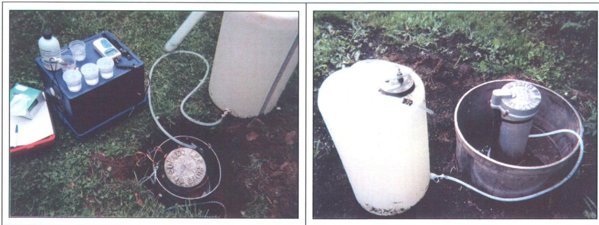
**Figure 13 :** Montage utilisé pour effectuer les essais de traçage
