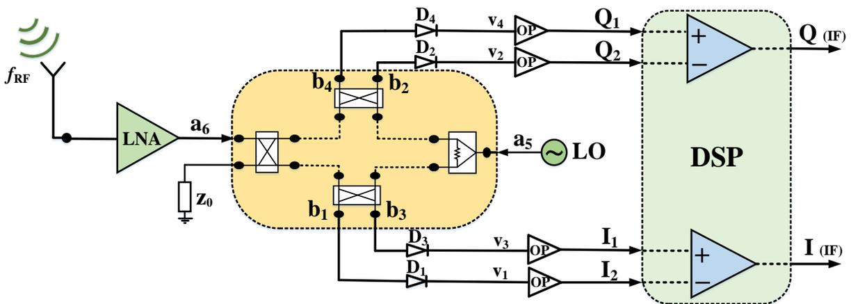
Figure A.1 Schéma du récepteur radio à six-ports.
