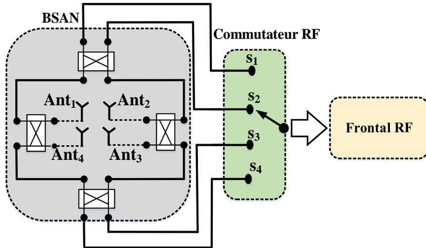
Figure A.3 Un schéma général du BSAN  $2 \times 2$  comprenant quatre entrées connectées au commutateur RF et quatre sorties en tant qu'éléments d'antenne rayonnants.
