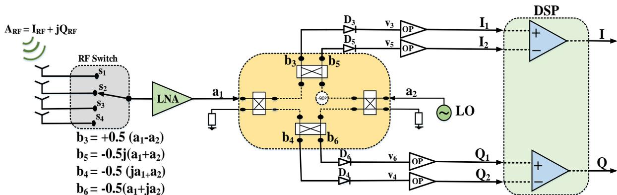
Figure A.4 Le schéma fonctionnel du frontal analogique pour la conversion descendante.
