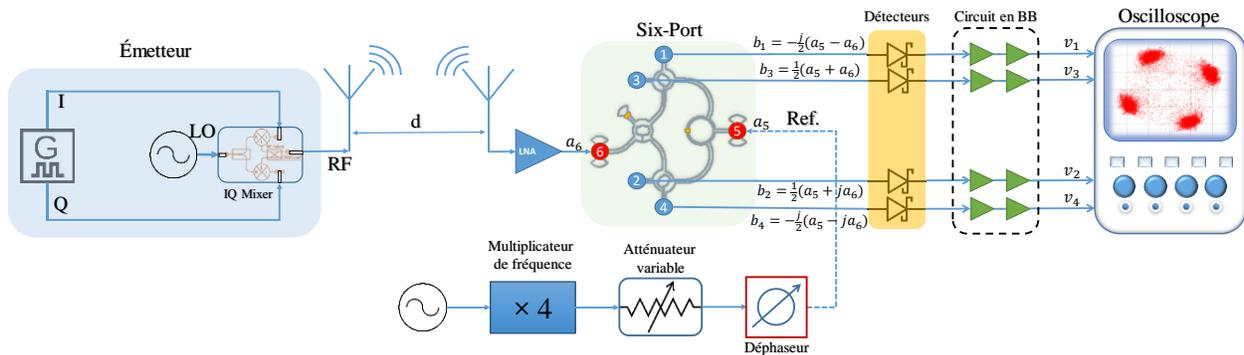
Figure A.2 Le schéma fonctionnel de la configuration système proposée, y compris le SPR pour la mesure des signaux de démodulation à haut débit de données.
