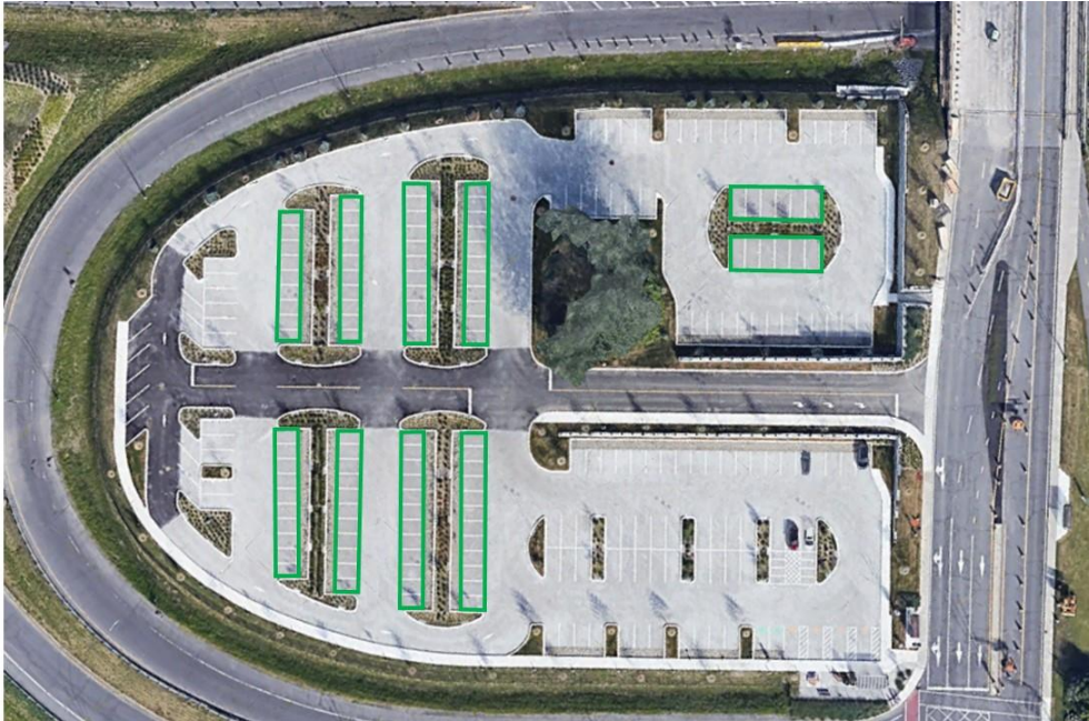
Figure 3.6 Localisation du pavage perméable imperméabilisé avec un polymère dans les encadrés en vert (adapté de Google Maps, 2021)
