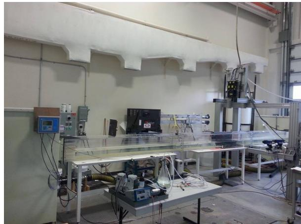
Figure 2.5 – Montage 2 : Les rides solides installées dans la partie centrale du canal. Le système PIV en mode stéréo est utilisé, caméras PIV en mode stéréo (2D-3C).
