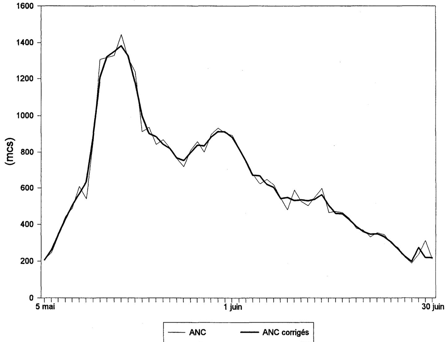
**Figure C.22** Apports non contrôlés (ANC) et apports non contrôlés corrigés du réservoir de Passes-Dangereuses (printemps 1959, saison moyenne)
