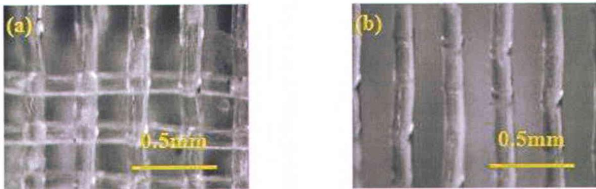
Fig. 7 (a) Le réseau original de polymère composé des tiges horizontales et verticales. (b) Le réseau de polymère une fois que les tiges horizontales aient été retirées.
