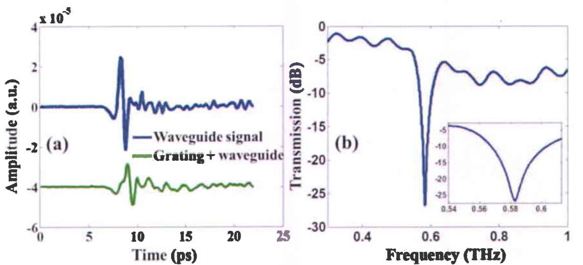
Fig. 8 (a) Signal provenant du guide d'ondes sans (bleu) et avec (vert) le réseau de polymère. (b) Spectre de transmission du signal THz avec le réseau de polymère. Le médaillon montre un vue rapprochée du minimum.
