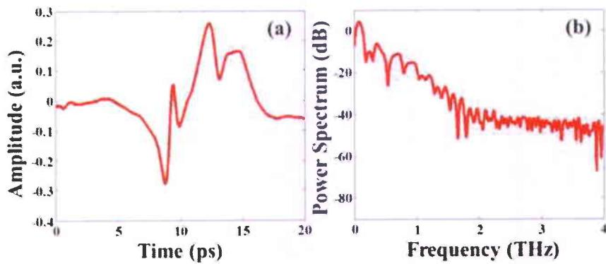
Fig. 13 (a) Signal temporel du guide d'ondes de 10 cm incluant une pièce de GaAs pièce entre les deux fils. (b) Spectra de puissance. Les courbes sont normalisées par rapport à leur maximum.
