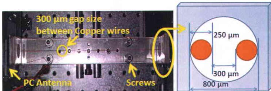
Fig. 4 Conception du guide d'ondes à deux fils avec le dispositif permettant d'obtenir une séparation de 300  $\mu\text{m}$ .
