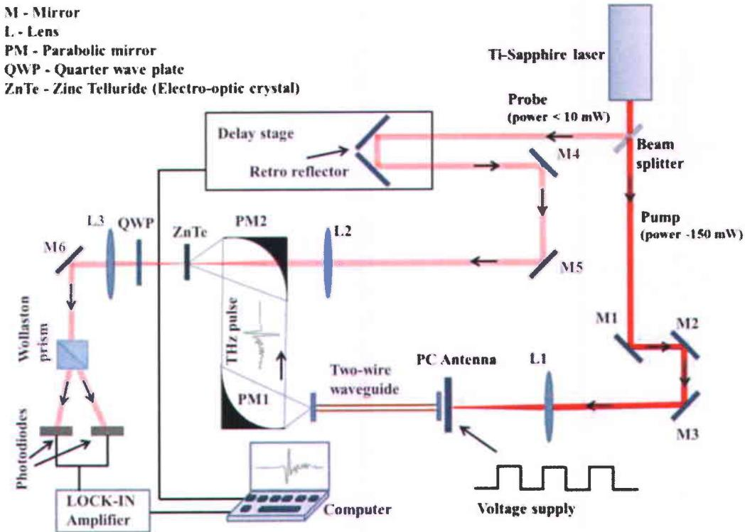
Fig. 5 Schéma expérimental utilisé pour la caractérisation du guide d'onde.
