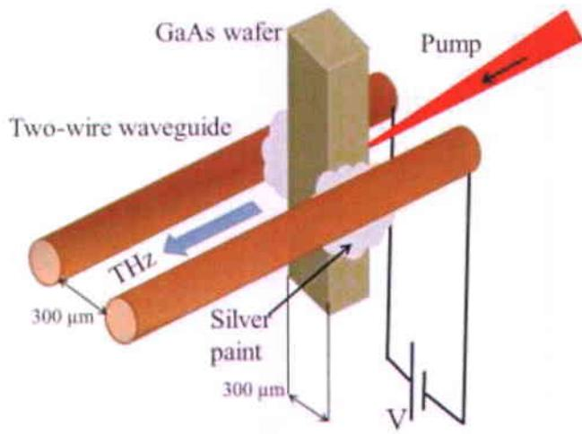
Fig. 10 Schéma du guide d'ondes à deux fils avec génération de rayonnement THz dans le guide d'ondes même (« émetteur THz à deux fils »).
