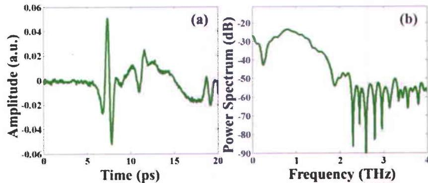
Fig. 12 (a) Signal temporel du guide d'ondes de 10 cm couplé à l'antenne PC composée d'un morceau de GaAs entre deux fils. (b) Spectra de puissance. Les courbes sont normalisées par rapport à leur maximum.
