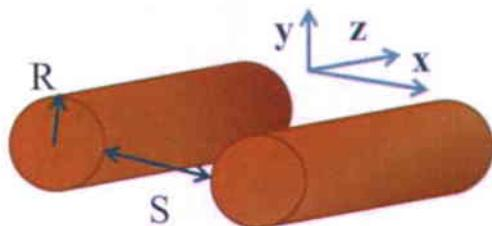
Fig. 2 Schéma d'un guide d'ondes à deux fils avec une séparation S et un rayon R. Le mode guidé se trouve dans le plan x-y et se propage dans la direction z.
