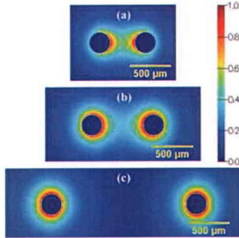
Fig. 3 Distribution du mode dans un guide d'ondes à deux fils pour des fils de 125  $\mu\text{m}$  de rayon et pour des séparations des fils de (a) 300  $\mu\text{m}$ , (b) 500  $\mu\text{m}$  et (c) 1500  $\mu\text{m}$ .
