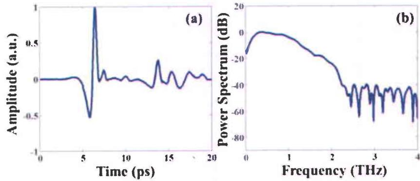
Fig. 11 Signal de la pièce de GaAs utilisée comme antenne PC sans le guide d'ondes: (a) Signal temporel. (b) Spectra de puissance. Les courbes sont normalisées par rapport à leur maximum.
