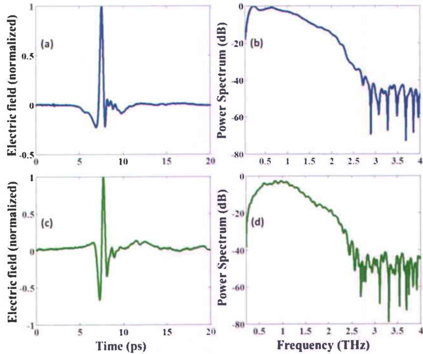
Fig. 6 (a) Signal temporel THz émis par l'antenne PC dans un environnement purgé et (b) le spectre correspondant. (c) Signal temporel THz du guide d'ondes à deux fils de 20 cm dans un environnement purgé et (d) le spectre correspondant. Toutes les courbes ont été normalisées par rapport à leur maximum.
