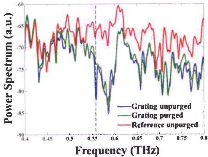
Fig. 9 Courbe bleue: Amplification de la raie de l'eau à 0.557 THz (tirets) dans le guide d'ondes incluant le réseau. Courbe rouge : Spectre obtenu sans le réseau dans les conditions ambiantes (non purgées). Courbe verte : Spectre obtenu avec le réseau dans un environnement purgé.
