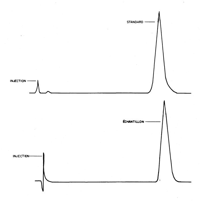
Figure 4. Chromatogrammes du matacil obtenus sous les conditions indiquées au tableau 2.
