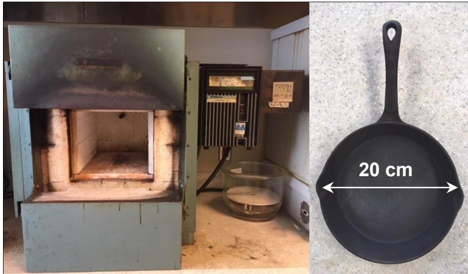
**Figure 4.3 Fournaise statique conventionnelle Furnatrol 133® et le poêlon utilisés pour les essais isothermaux**
