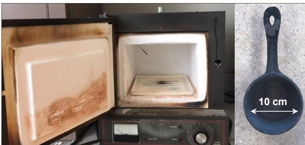
Figure 4.1 Fournaise M-525 et poêlon utilisés pour les essais de traitements progrades
