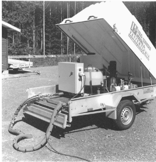
Figure 2. Unité mobile de TRT développée à l'Université de technologie de Luleå (tirée de Gehlin, 2002, photo: Peter Olsson).
