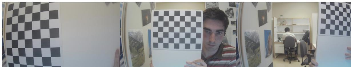
Figure 5.14 : Exemples de clichés acquis d'un damier de calibration pour l'orientation intérieure
