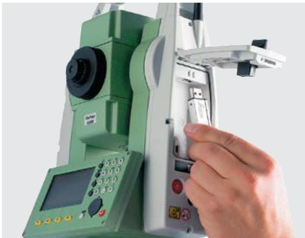
Grâce à la technologie Bluetooth® intégrée à la Leica Flexline TS06plus, vous pouvez connecter votre station totale à un collecteur de données sans utiliser de câble, tel que les carnets de terrain Leica Viva C10/CS15 équipés du logiciel SmartWorx Viva. La clé USB facilite le transfert de données telles que GSI, DXF, ASCII, LandXML et CSV.
