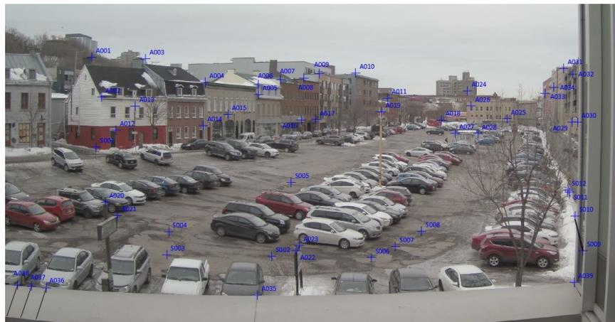
**Figure 3.13 : Station totale Leica TS16 et points d'appui définis sur le stationnement de la rue Dorchester**
