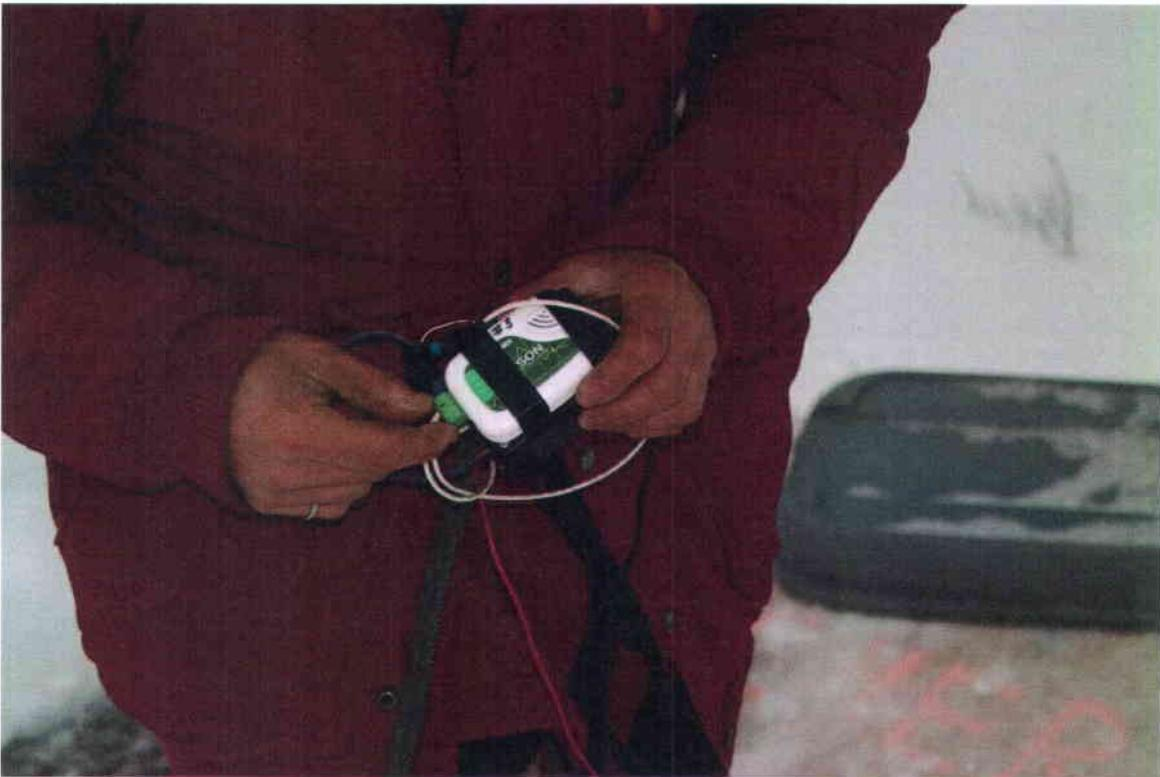
Figure C5 : Système d'acquisition *Dickson* d'un lysimètre passif
