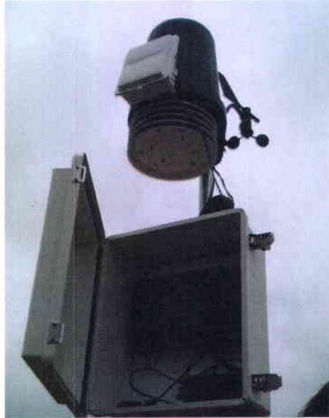
**Figure 2.6** : Station météorologique Vantage Pro avec la console Weatherlink 5.6
