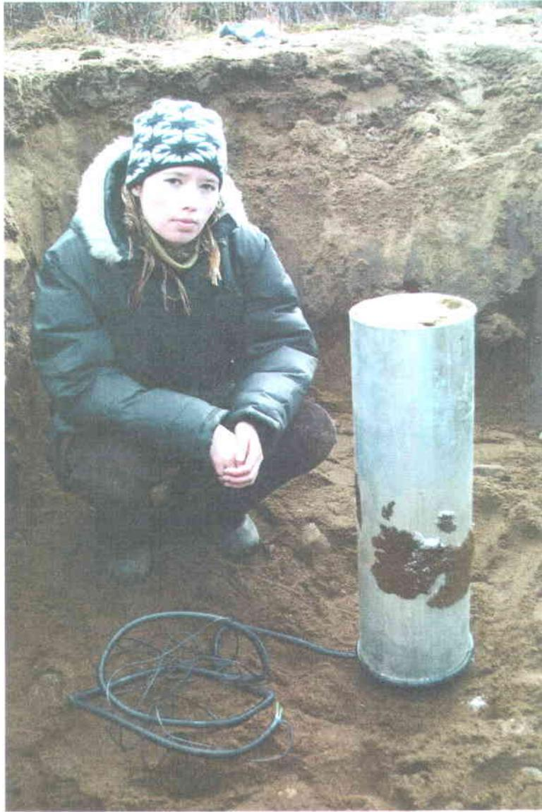
Figure C6 : Lysimètre passif en place
