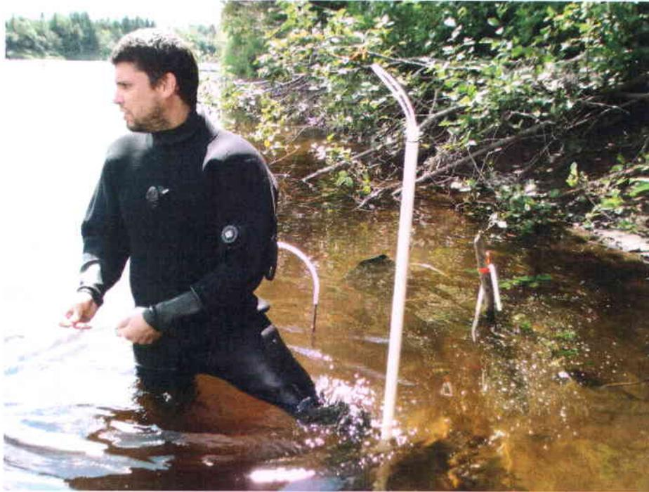
Figure C15 : Piézomètre de PVC à une profondeur de 0.5 m
