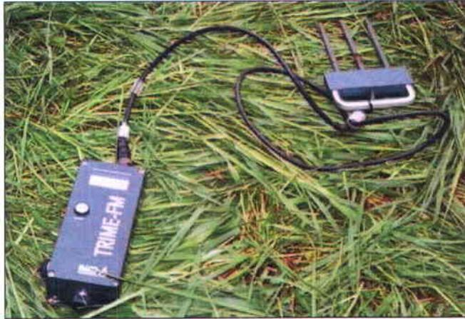
**Figure 2.10:** Sonde TDR - Time Domain Reflectometry (tirée de Allaire, 2003)
