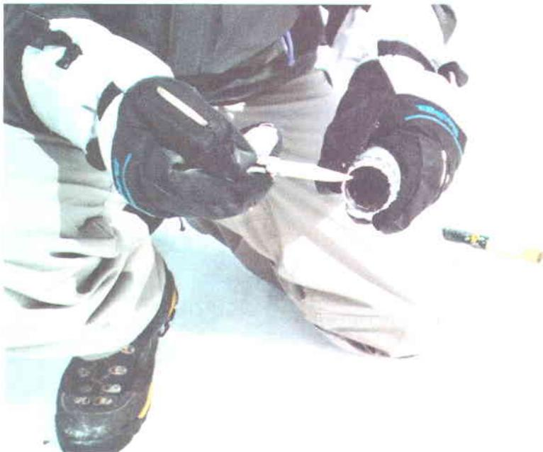
**Figure 2.9:** Nettoyage du bout du carottier
