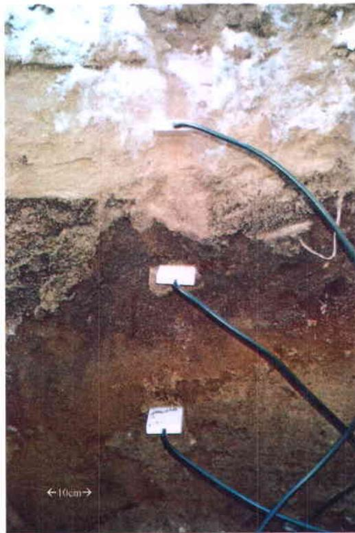
**Figure 2.11 :** Sondes TDR mises en place au plateau
