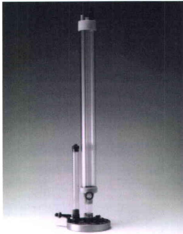
**Figure 2.5** : Infiltromètre à tension (tiré de Soilmoisture Equipment corp., 1997)
