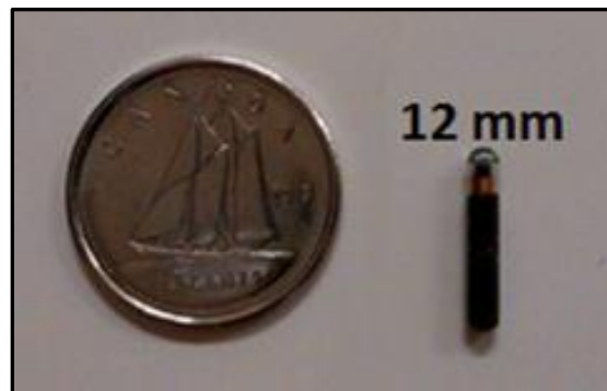
Figure 4. 2 : Transpondeur passif de 12 mm utilisé pour le marquage des poissons.
