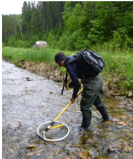
Figure 4. 4 : Balayage du cours d'eau avec l'antenne portable.
