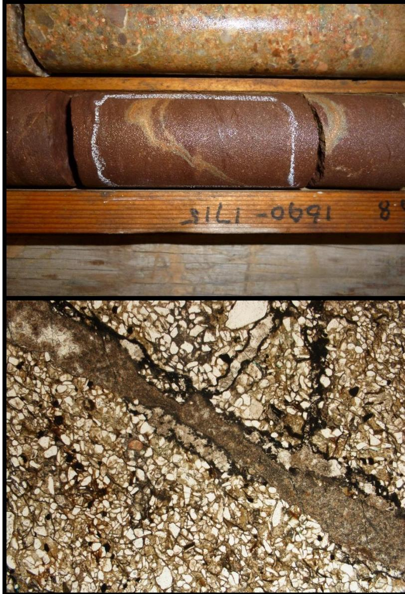
**Figure 3-8. Fracture remplie avec zone de lessivage (puits AZ53 1700'); vue en carotte et en lame mince. (25x)**
