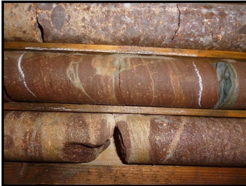
**Figure 3-17. Zone silteuse fracturée.**
