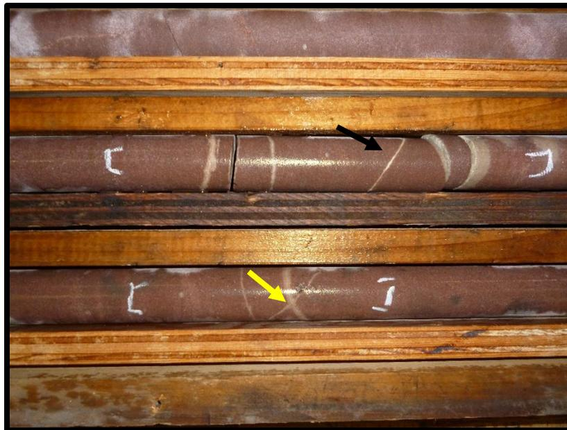
**Figure 3-9. Fracture remplie (jaune) et fracture cimentée (noir ; puits AZ47).Fracture ouverte (puits AZ 47)**
