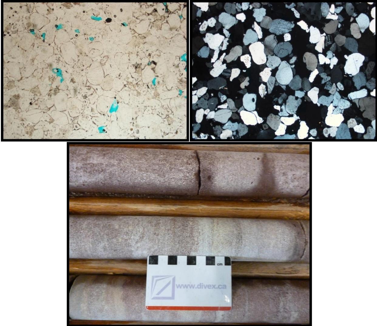
**Figure 3-15. Grès à haute teneur en quartz, cimenté, montrant une faible porosité. De droite à gauche lame mince (25x), lame mince lumière polarisé (25x), carotte.**
