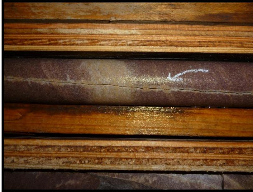
**Figure 3-10. Fracture ouverte (puits AZ 47)**
