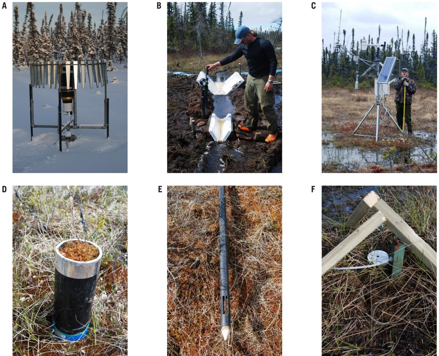
**Figure 6 :** Instrumentation de terrain: précipitomètre (A), canal trapézoïdal (B), station météorologique (C), lysimètre (D), piézomètre (E), et trépied permettant la mesure de l'oscillation du sol (F).
