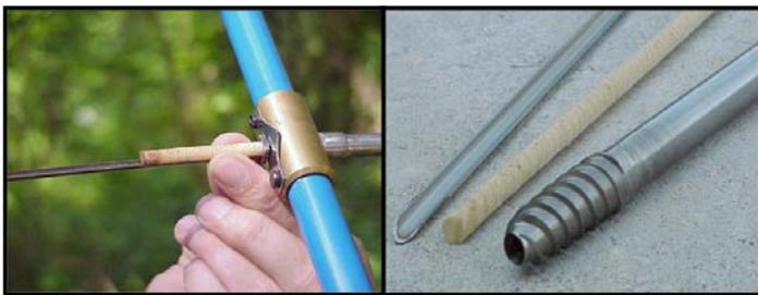
**Figure 4** : Sonde de Pressler de 5 mm et carotte de bois échantillonnée.
