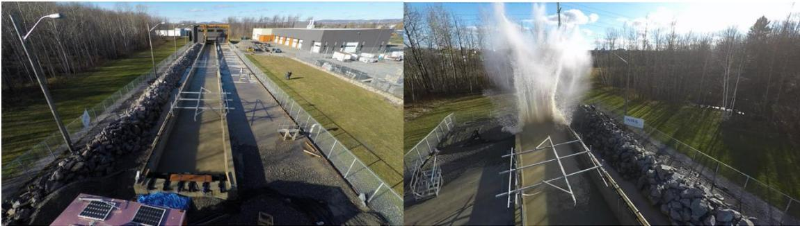
**Figure 3. Vue d'ensemble du canal et exemple d'impact de vague sur le mur.**
