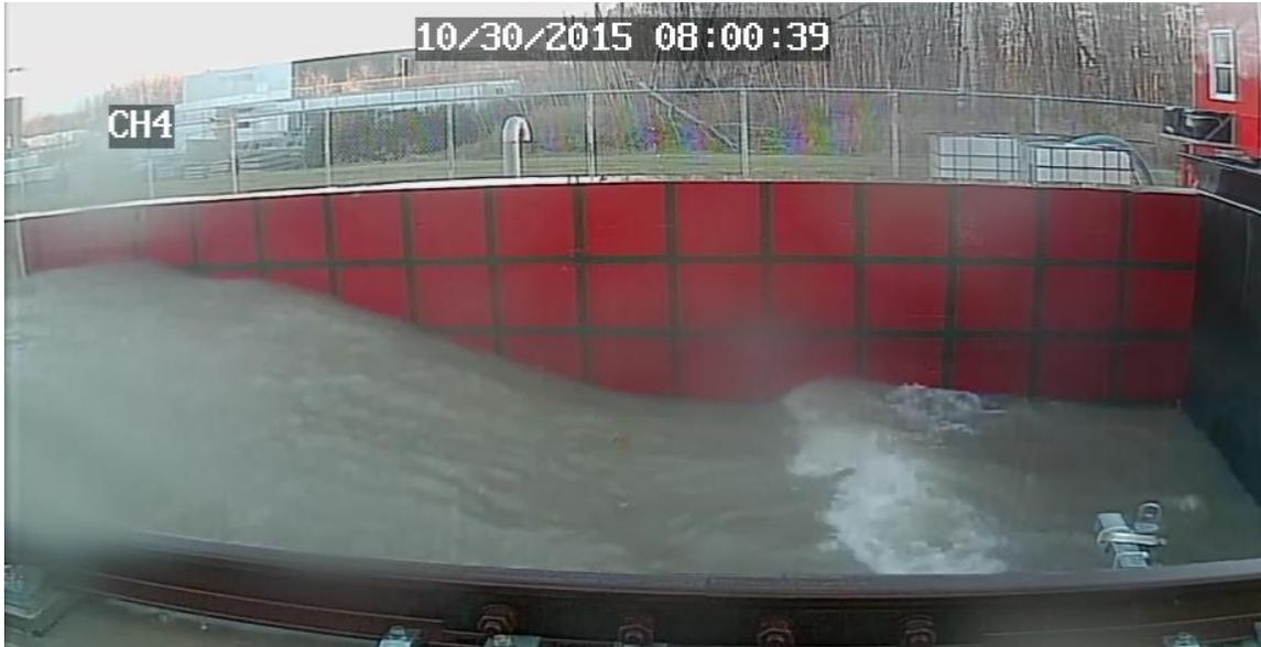
Figure 15. Une petite réflexion de vague sert de tremplin à une plus grosse vague incidente et la propulse par-dessus le mur (ctrl+clic sur l'image pour visionner la vidéo).
