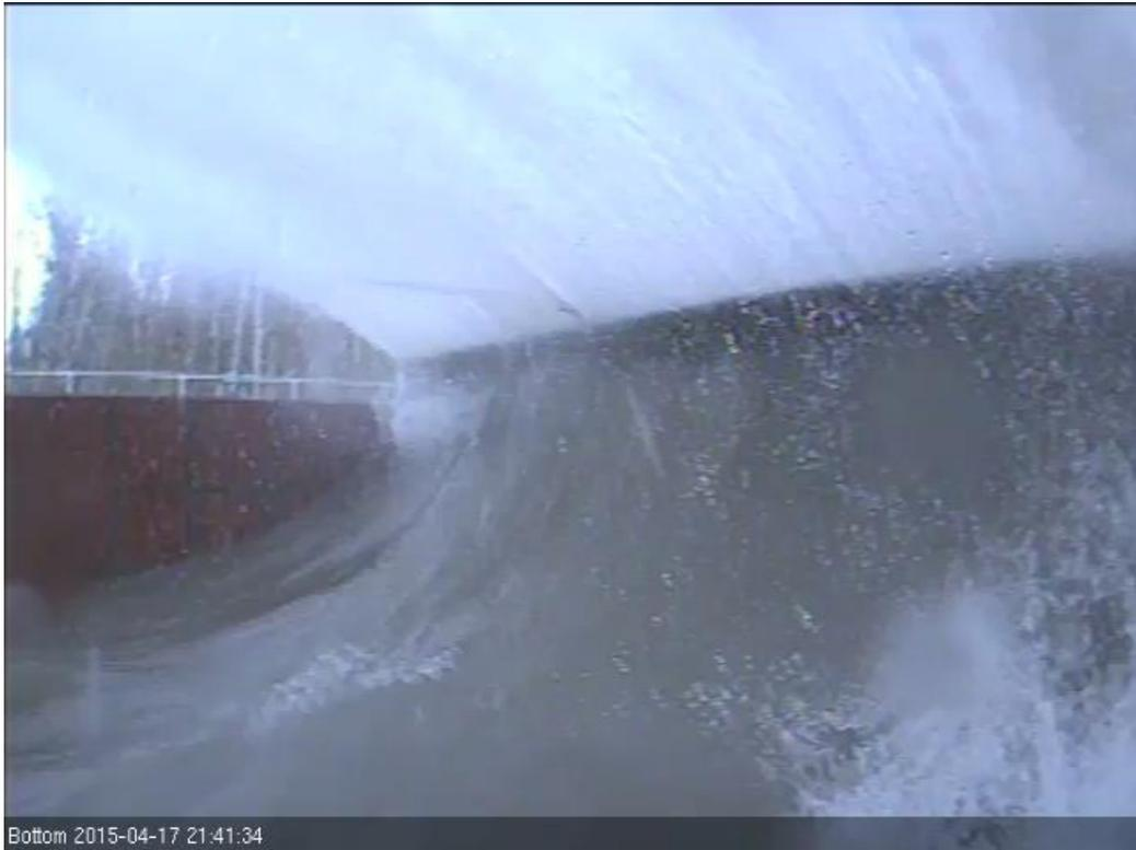
**Figure 41. Vidéo de l'impact #110-4 montrant le jet dévié par le déflecteur.**
