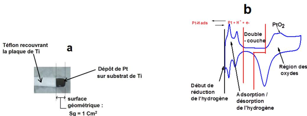
Figure 2.10 : a) Représentation de la surface géométrique du dépôt de Pt sur plaque de Ti. b) Répartition des différentes régions d'adsorption/désorption de l'hydrogène et de formation d'oxydes sur Pt polycristallin en milieu acide. 0,5 M H<sub>2</sub>SO<sub>4</sub>,  $\nu = 50$  mV/s
