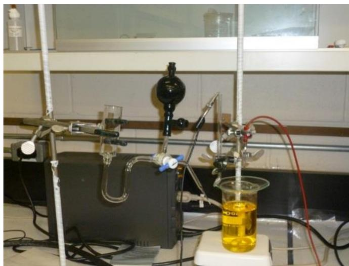
**Figure 2.4 : Montage pour déposition des métaux sur plaque de titane.**
