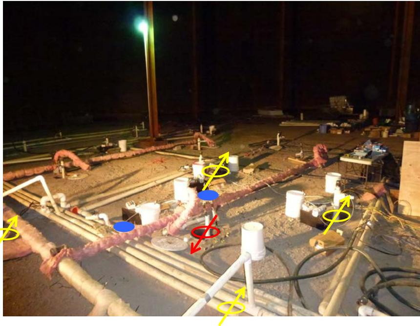
Figure 10. Patron d'injection en 5 points situé dans le réservoir. Le puits d'injection PS11-2 est visible au centre du patron (en rouge), et les quatre puits d'extraction (P11-2, P11-3, P11-7 et P11-8) aux quatre coins du patron (en jaune). Deux puits d'observations (PO-03 et PO-04, en bleu) sont présents à mi-chemin entre le puits d'injection et deux puits d'extraction. Les conduites au sol font partie du système d'extraction multiphase en exploitation
