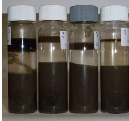
**Figure 3.2 – Essais d’adsorption en lot avec sol du site – tensioactifs anioniques (1 : sol site + eau; 2 : sol site + TENSIOACTIF E (pH7); 3 : sol site + TENSIOACTIF E (pH1); 4 : sol site + TENSIOACTIF B)**
