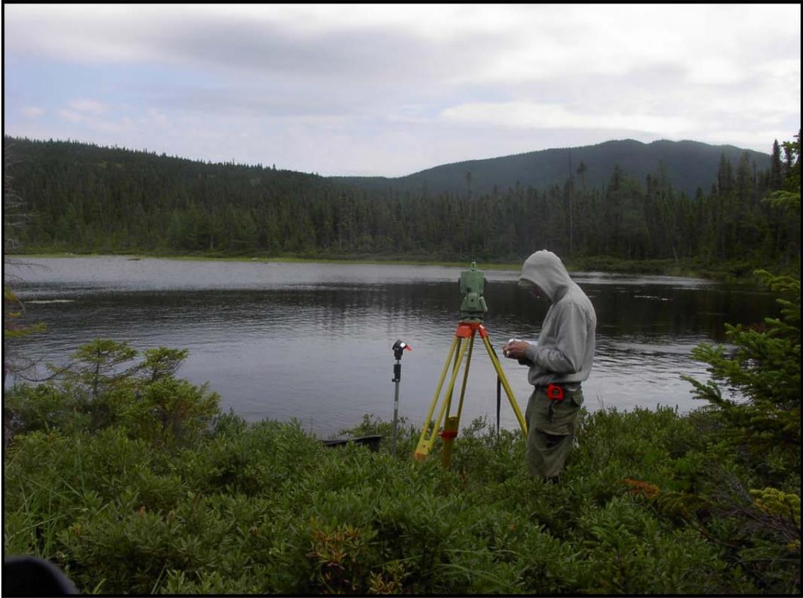
**Figure 14. Levé bathymétrique à l'aide d'une station totale**
