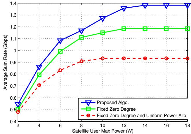
**Figure 5:** La somme des taux moyens vs la puissance maximale de l’utilisateur du satellite pour  $K = 14$ ,  $J=7$ , SNR moyen = 15dB,  $\bar{I}_{i,n}^{\text{TH}}$  sont définies aléatoirement.
