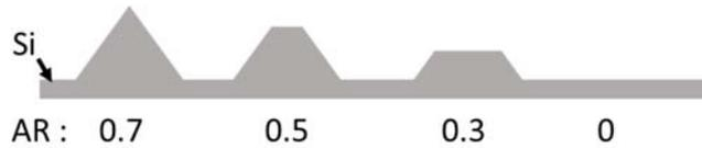
**Figure 5-4.** Schéma montrant l'évolution du rapport d'aspect (RA) des pyramides en fonction du polissage
