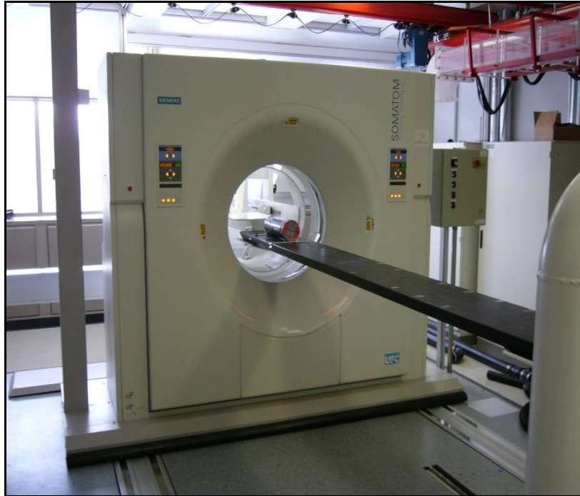
Figure 3.2 Scanneur médical Siemens Somatom Volume Access du Laboratoire de Scannographie de l'Institut National de la Recherche Scientifique (INRS).
