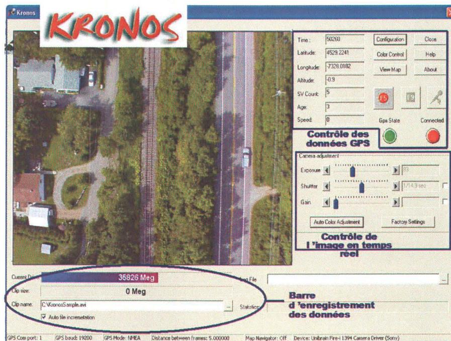
Figure 2.13 – Interface du logiciel d'acquisition de données vidéographiques Kronos<sup>®</sup>. (source : GÉO-3D Inc.)
