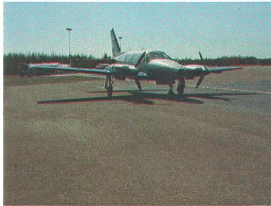
Figure 2.11 – Avion bimoteur Navajo ayant été utilisé pour les relevés aériens. (source : *GÉO-3D Inc.*)
