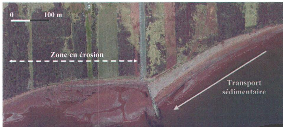
Figure 1.31 – Vue aérienne de l'épi de la plage à Norbert. La flèche indique la direction du transport sédimentaire littoral. La perturbation générée par la présence de l'épi est clairement visible. Mosaïque réalisée à partir de vues vidéographiques (source : GÉO-3D Inc.).
