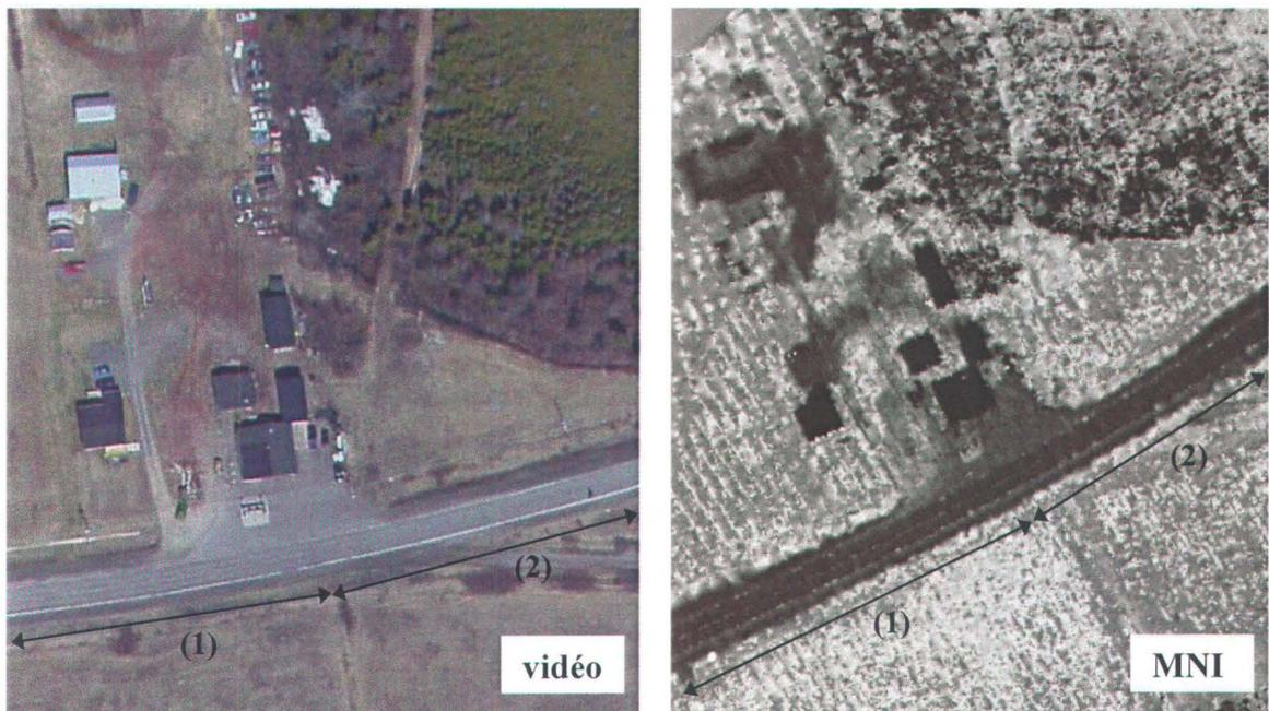
Figure 4.1 – Portion de route où les marquages au sol peuvent être source d'ambiguïtés lors de la numérisation à partir de MNI (secteur de Saint-Godefroi – Shigawake). Si la ligne centrale de la route est visible dans la partie gauche des images(1), elle disparaît graduellement dans la partie droite (2).
