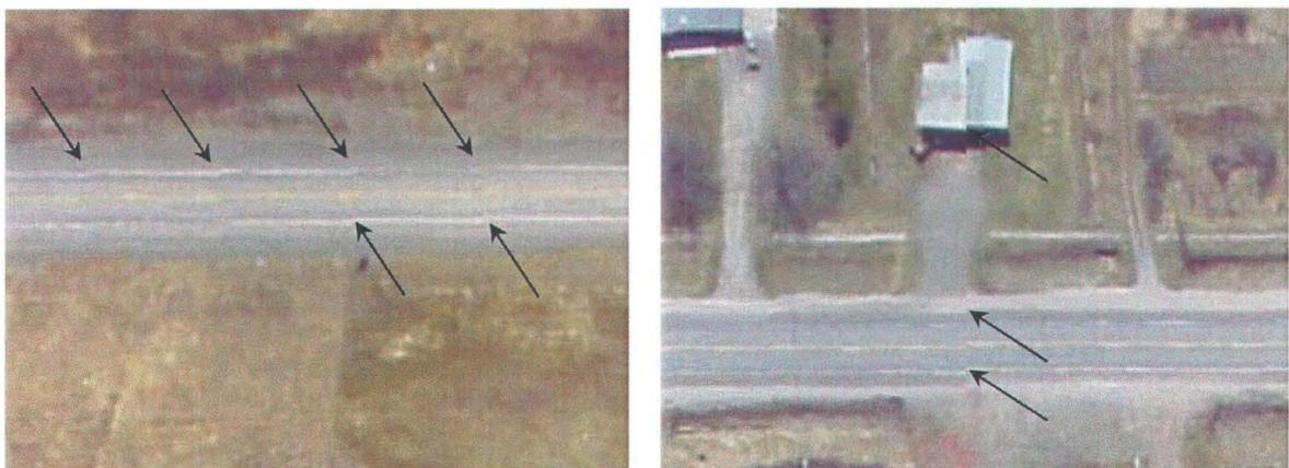
Figure 3.2 – Détails de mosaïques montrant les décalages pouvant subsister entre certaines images. Ceux-ci sont très faibles sur l'image de gauche (environ 0,30 m) mais restent perceptibles au niveau des lignes continues. Un décalage plus important (environ 1 m) est visible sur l'exemple de droite, en particulier au niveau de la route et de la maison.
