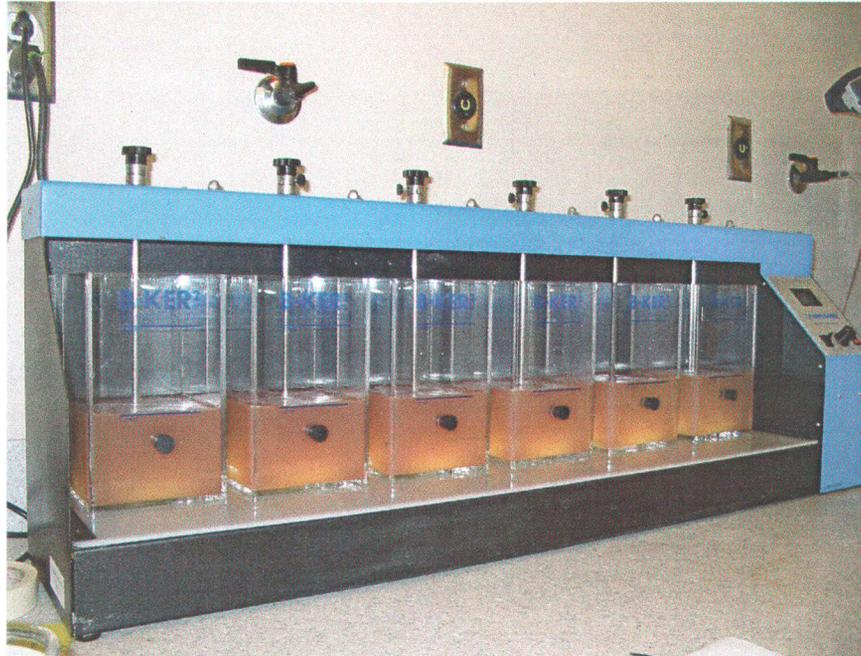
Figure 14 Jar test utilisé pour les essais de coagulation chimique
