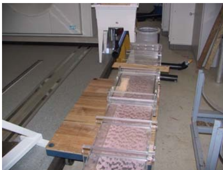
Fig. F.6 – Partie inférieure de canal avant assemblage.
