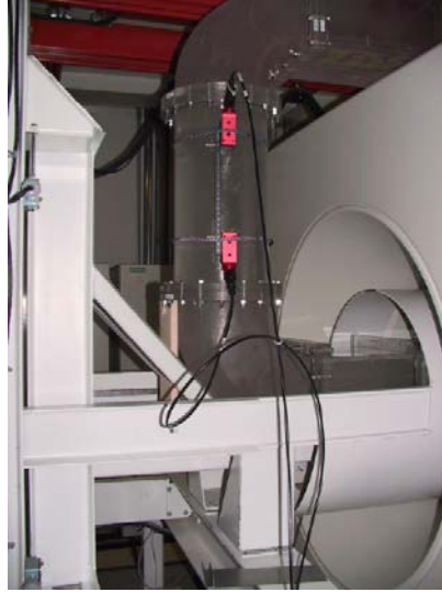
Fig. F.8 – Capteur Doppler monté sur le canal.
