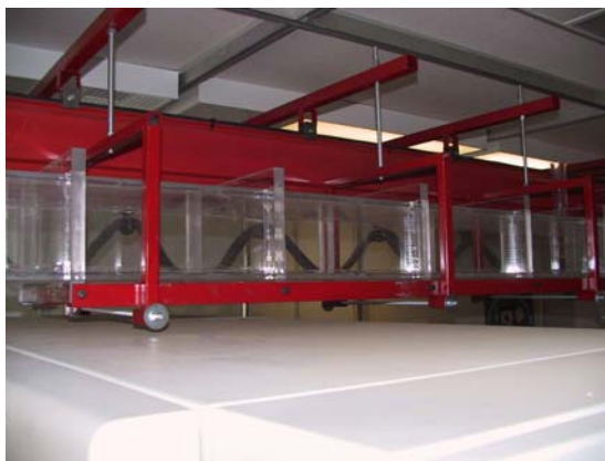
Fig. F.3 – Fixation et partie supérieure du canal.
