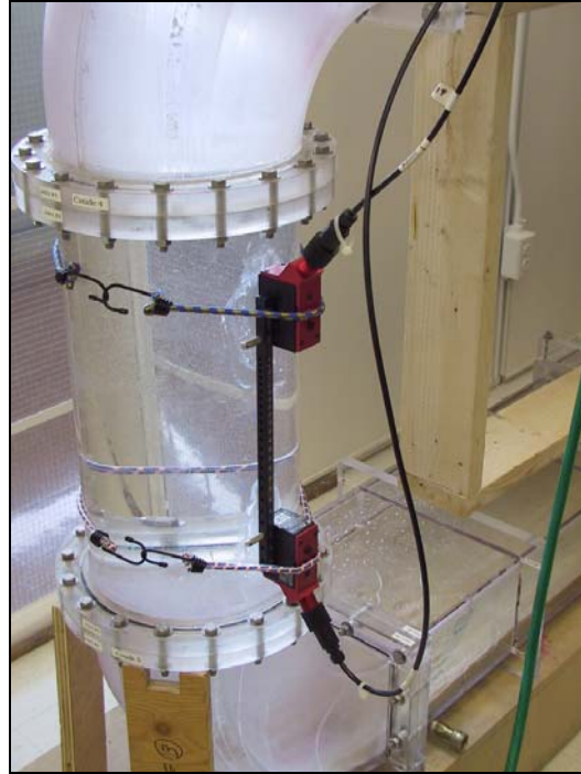
Fig. 1.8 - Capteur Doppler de la partie ascensionnelle du canal.
