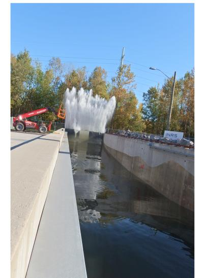
Photo 11. Expérience d'impacts de vagues sur un mur de protection. Les impacts sont mesurés à partir d'une plaque de capteurs. Le modèle est à une échelle 1:4.
