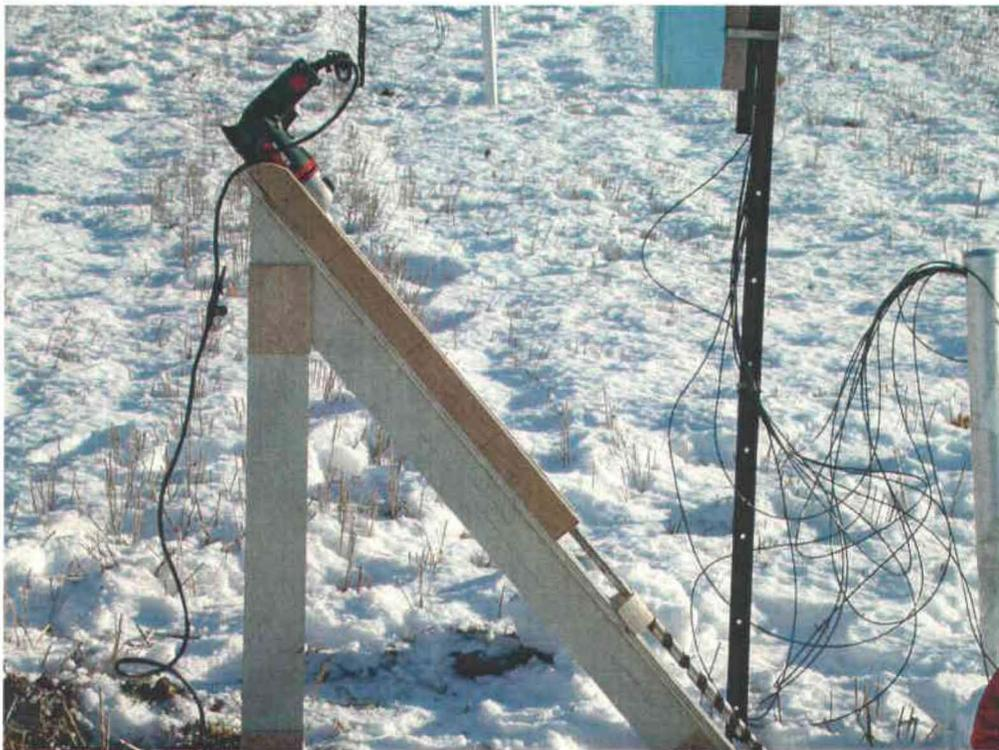
Figure 14 : Lysimètre chauffant inséré à 45° dans le sol
