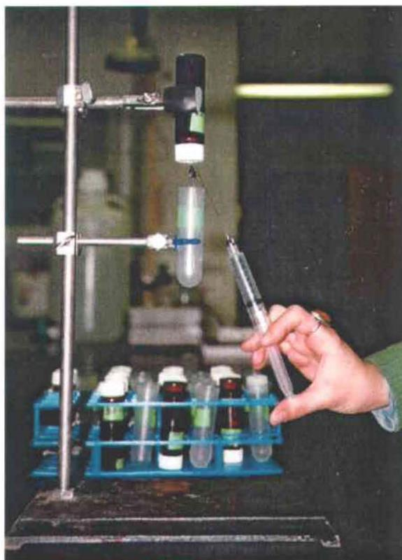
Figure 15 : Montage pour le dégazage du N<sub>2</sub>O soluble par la méthode du « headspace » (espace de tête) ; introduction d'un volume de N<sub>2</sub>
