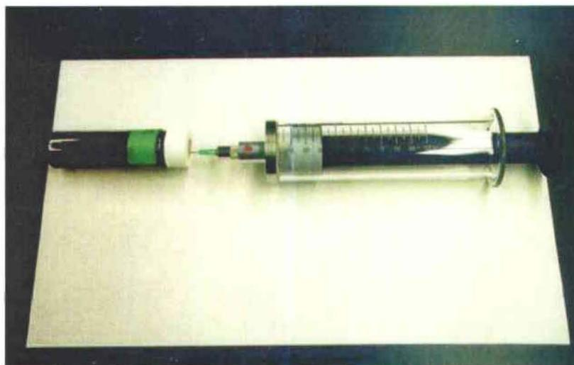
Figure 16 : Prélèvement d'un volume de gaz à l'équilibre entre l'eau de l'échantillon et le « headspace » à l'aide d'une seringue à valve
