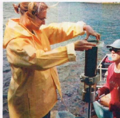
**Figure 2.5** Extrusion d'une carotte de sédiment.
