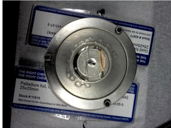
**Figure 8 : Photographie d'une cible mixte de PdCuAu, utilisée lors de la déposition en simple faisceau, on peut discerner des feuilles de palladium et d'or (couleurs argentée et dorée) recouvrant une cible de cuivre (couleur cuivrée).**
