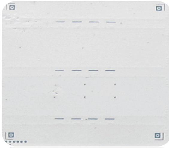
**Figure 15 Réseau d'antennes fabriqué avec  $N = 4$ , la transition conçue au chapitre 7 est appliquée sur les deux côtés**
