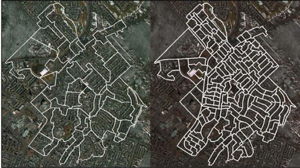
**Figure 5.10 : Découpage du territoire en sous-bassins pour le secteur B (À gauche, la représentation d'origine fournie par la ville et à droite, la représentation développée dans le cadre de la présente étude après redécoupage du territoire).**
