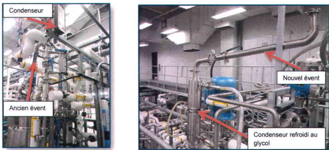
Figure 14 : Photos représentant les changements opérés sur le fermenteur de 150L (photos prises par Adama ndao, le 15-03-2014).
