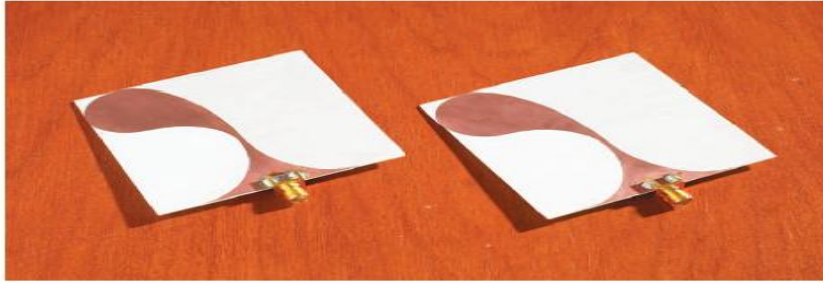
Figure.17- L'antenne Vivaldi antipodale développée dans [6].
