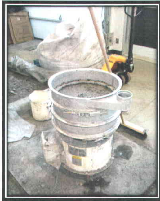
Figure 3.1 Tamis Sweco utilisé pour effectuer les essais de tamisage
