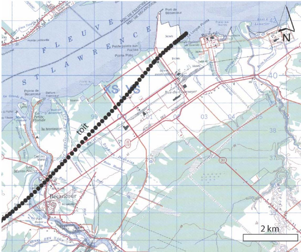
**Figure 5. Projection en surface de la faille de Yamaska (ronds noirs) à partir du modèle géologique 3D de la sous-surface. Le modèle géologique a été établi par l'équipe de la chaire de séquestration du CO<sub>2</sub> à partir des données de forages et sismiques disponibles.**
