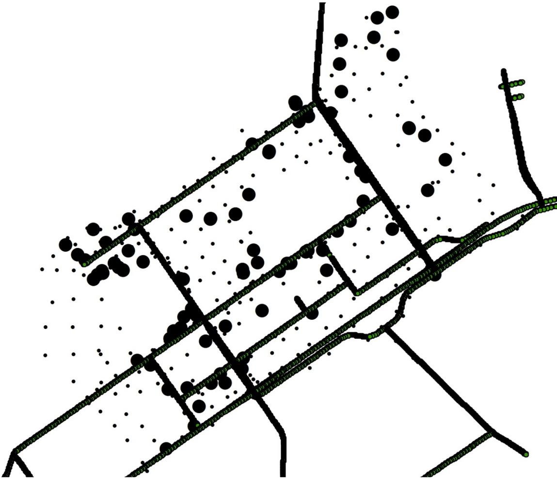
Figure 1. Données utilisées. Les lignes figurent les routes discrétisées en points, les petits points noirs sont les sites avec de faibles concentrations en hydrocarbures gazeux (non-anomaliques) et les gros points noirs sont les sites avec des concentrations anormales (95<sup>ème</sup> percentile) en éthane, propane ou butane.
