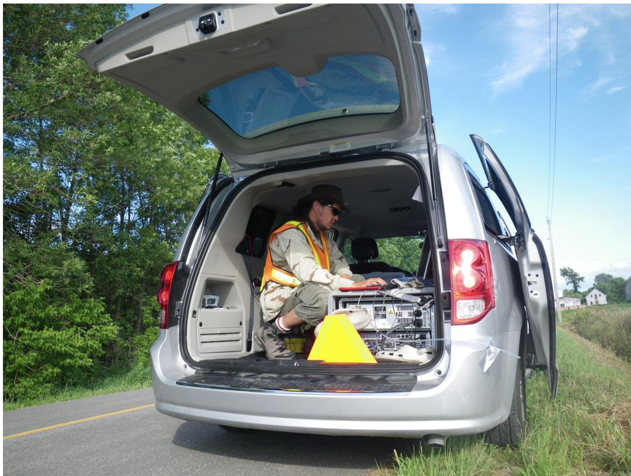
**Figure 11. Échantillonnage du CO<sub>2</sub> atmosphérique utilisé en 2011. Un véhicule est stationné le long de la route. Le spectromètre laser est embarqué à l'arrière du véhicule. Il est alimenté par des batteries 12v. L'entrée d'air est visible à l'arrière droit.**
