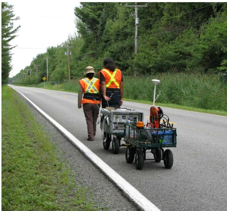
**Figure 10. Dispositif mobile d'échantillonnage du CO<sub>2</sub> atmosphérique au niveau du sol (concentrations et ratios isotopiques). Deux opérateurs tractent un spectromètre laser (premier chariot) qui enregistre des mesures en continu. Il est alimenté par un set de batteries à décharge profonde (second chariot). Un GPS enregistre les positions spatiales des mesures.**
