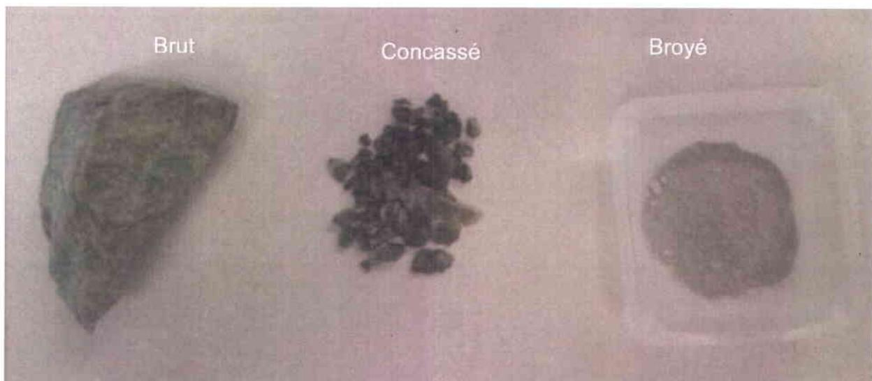
Figure 1.14 Illustration du résidu sous sa forme brute, après concassage puis après broyage
