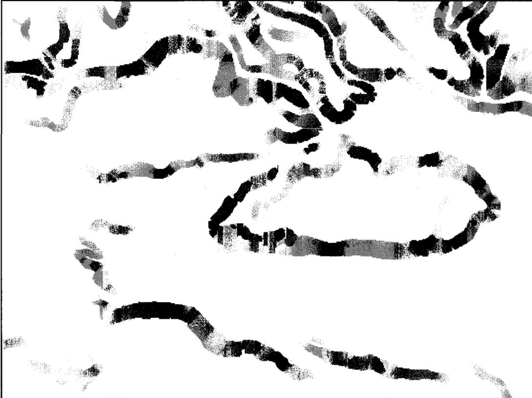
Figure 6.15 : Carte de la probabilité de rupture (aléa spécifique) calculée en utilisant une superficie de glissement de terrain de  $350 \text{ m}^2$ , secteur des Bouleaux. Du pâle au foncé, la probabilité de rupture passe de  $2.8 \times 10^{-5}$  à  $6.0 \times 10^{-3}$ . Les dimensions du secteur sont d'environ  $1100 \times 850 \text{ m}$ .
