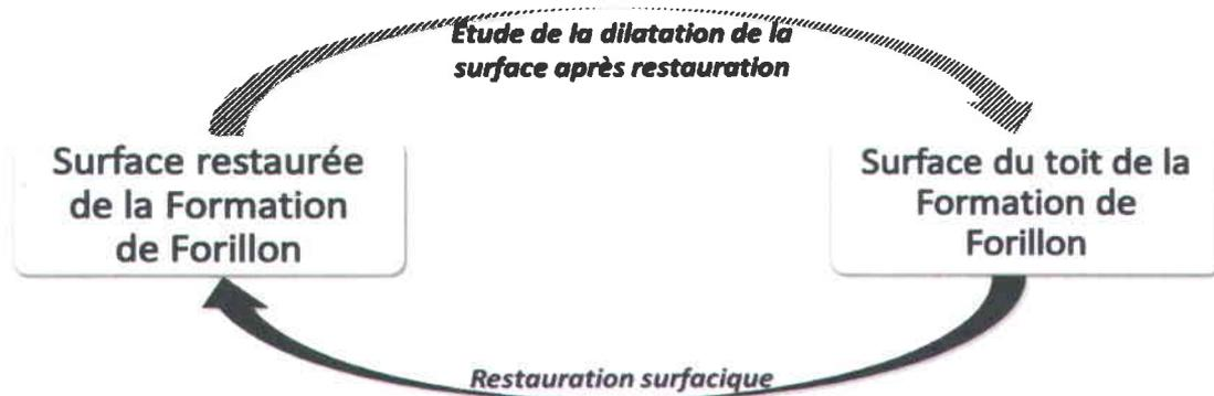
Figure 3.16 : Méthode de travail pour la restauration surfacique du toit de la Formation de Forillon. L'étude de la dilatation sur la surface restaurée permet de faire un travail itératif afin d'obtenir une surface avec un minimum de déformation partant du postulat que la Formation de Forillon est une formation pas ou peu déformée.
