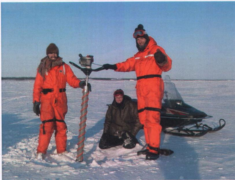
FIG. 3.10 – Le carottier utilisé par l'équipe de l'INRS pour l'extraction de la glace sur la rivière Koksoak (mars 2009)
