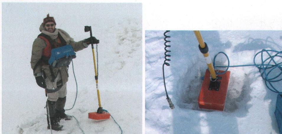
FIG. 3.15 – GPR utilisé pour l'extraction de l'épaisseur du couvert de glace. La fréquence de l'antenne est de 900 MHz
